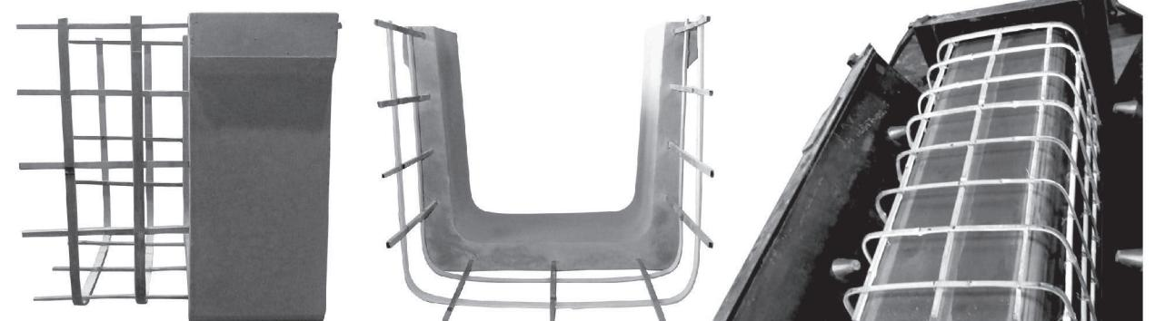
竹筋コンクリートの実用化を成功させるためには強度や耐久性および生産性が大きな課題となります。私たちは日本大学工学部コンクリート研究室および機械工学研究室と実験を重ね、大型の建物や橋などでなければ、実用化にかなう強度があることを確認できました。さらに竹は強アルカリ性のコンクリートの中でも腐食に強く、耐久性があることもわかったのです。
